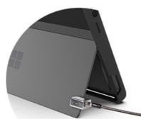
保護ケースを装着したまま、KensingtonのSurface Pro専用ロック(鍵式、コンビネーション式)を取り付けることができるので、デバイスの盗難防止も行うことができます。
