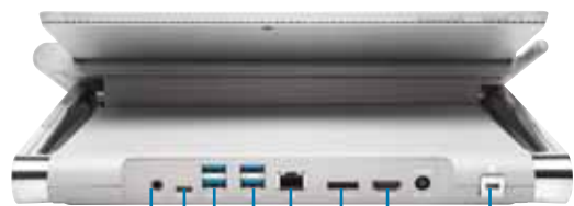
Ingresso/uscita audio combinati da 3,5 mm USB-C™ 4 porte USB 3.0 Gigabit Ethernet DisplayPort++ HDMI Kensington Security Slot™
