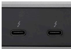
Thunderbolt4テクノロジーによりさらに2台のThunderbolt搭載デバイスへの接続可能。(最大5台) 40Gbpsでのデータ転送可能、デュアル4Kビデオおよびオーディオ出力が0.8mのThunderbolt4ケーブルに接続するだけでPlug&Playで使用できます。Intel VT-d DMAメモリアクセス保護により許可されていない周辺機器をノートPCのメモリーへのアクセスを防止します。
