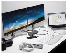
Thunderbolt4搭載Windowsデバイスにシングル8K@60Hz(DSC1.2 HBRのホストデバイスにおいて)またはシングル4K@120Hz/デュアル4K@60Hzまたはデュアル1080p(@120Hz)ビデオ出力でウルトラHDによる鮮明な解像度とコントラストや色深度を実現します。他のデバイスの解像度については別表を参照。
