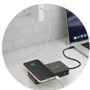
デバイスをUSB-Cパワーアダプターに接続してパワーパススルーを行うことで(USB-Cデバイスは給電対応である必要があります)、ドックに接続したアクセサリに給電することができます。
