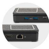
HDMIポート2つでデュアル4K@60Hz接続に対応。USB-CホストデバイスはDisplayPort AltModeに対応している必要があります。USB-C接続のMacBook、iPad、Samsung DeXデバイスもシングル4K@60Hzで対応。
