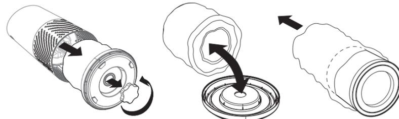
Desenrosca la perilla, afloja la cubierta inferior y retira la bolsa de plástico del filtro.
