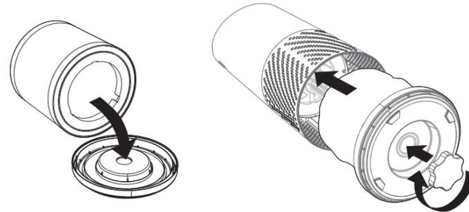
Asegura el filtro en la cubierta inferior, desliza ambos en el purificador y vuelve a colocar la perilla.
