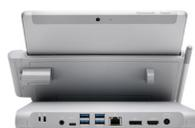
USB-Aポート×4、イーサネットポート×1、Display Port++×1、HDMI×1、USB-Cポート×1、3.5mmオーディオジャックを備え、Plug&PlayでSurface Goを接続するだけでデバイスの生産性を最大限に高めることができます。
